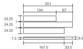
ECP-2520NB 磁磚形狀圖 (詳細)
