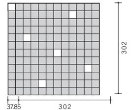
LUX11、LUX12、LUX13 具有方向性，以左上為亮色磚片向上排列，為標準施工方法。
